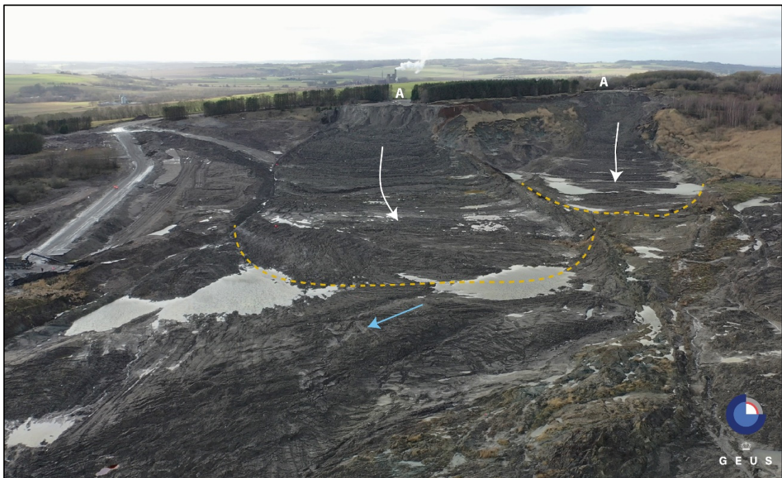
Figur 2. Dronebillede fra den 31. januar 2024 af den vestlige del af skredområdet kiggende mod vest. De to jordstrømmes front er markeret med gule stiplede linjer og bevægelsesretningen mod øst er indikeret med hvide pile. Aflæsningspladserne er markeret med A. Foran jordstrømmene ses jord fra den centrale del af deponiet med deformerede spor af bulldozerne, hvoraf et af dem er markeret med en blå pil.
